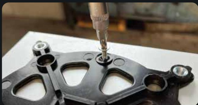
3. Quindi, avvitare saldamente tutte e otto le viti con le rondelle nella superficie. Assicurarsi che le viti siano serrate uniformemente per fornire un fissaggio sicuro.
